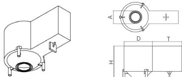
Einbetonierbüchse inkl. Trafotunnel
