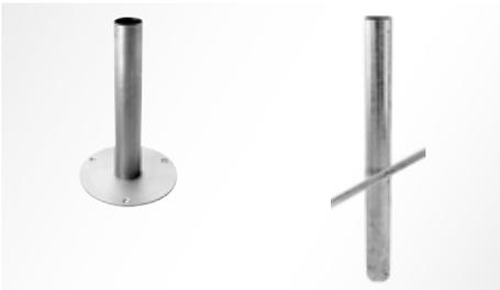
Für die Version KHA SLIM 220 kann die Bodenbefestigung über ein Erdstück aus verzinktem Stahl direkt im Beton erfolgen oder über einen Edelstahlsockel, der mit Dübeln (im Lieferumfang) am Boden befestigt wird, beides als Zubehör lieferbar.
