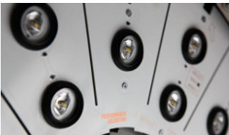
Zu jeder LED gehört ein elektronisches Sicherheitsgerät (NUD), das diese bei Störungen überbrückt
