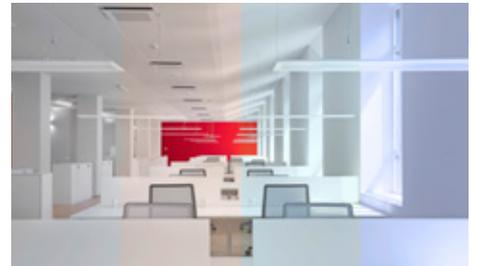
Die HCL und Tunable-White Versionen bilden den dynamischen Tageslichtverlauf nach und variieren Beleuchtungsstärkeniveau und Lichtfarbe von 2.700K bis 6.500K abhängig von der Tageszeit.
