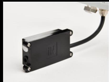
Externer Anschlusskasten für den elektrischen Anschluss aus Technopolymer. Geeignet für Kabel Ø 6–9 mm aus Gummi. Er wird mit einem 25 cm langen Kabel an die Leuchte angeschlossen.
