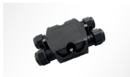
Branchement électrique au moyen d'un connecteur rapide prise-fiche réalisé en PA66 sans halogène ni phosphore avec contacts en cuivre argenté, pour les câbles Ø 9 à Ø 14 mm.
