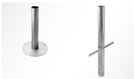
Pour la version KHA SLIM 220, la fixation au sol est réalisable à l'aide d'un socle en acier galvanisé à sceller directement dans le ciment ou une base en acier inox à fixer au sol à l'aide de tiges de scellement (comprises), les deux étant disponibles comme accessoires.
