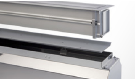
Chaque kit de fixation à encastrer est muni d'un couvercle de protection afin d'éviter toute éventuelle déformation lors des phases d'installation dans du ciment.
