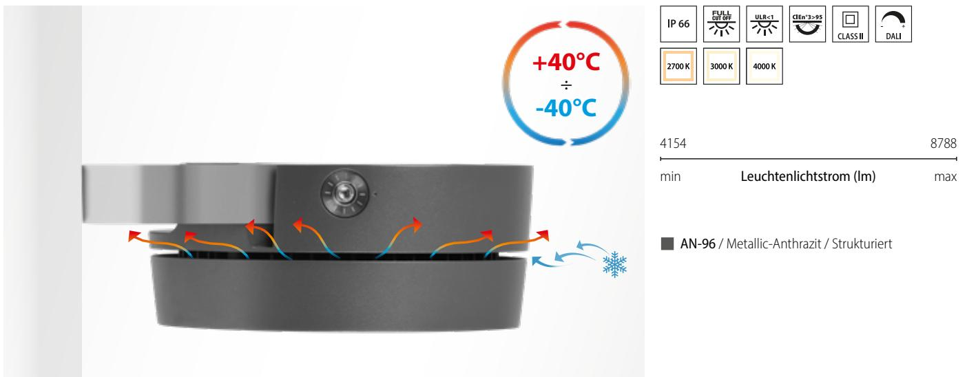
Leuchtenkörper bestehend aus zwei getrennten Kammern, die eine maximale Wärmeableitung von den elektronischen Teilen und LEDs gewährleisten. Hergestellt aus Aluminiumdruckguss, lackiert mit Polyesterpulverbeschichtung ISO 9227
