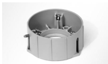
Sockelelement zur Bodenbefestigung aus Aluminium-Druckguss durch chemische Oberflächenbehandlung vorbereitet und mit Polyesterpulver beschichtet.
