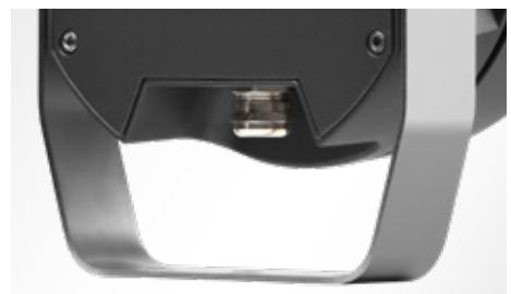
Kabelverschraubung aus vernickeltem Messing M20x1,5 für Kabel mit Ø 10-14 mm
